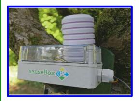
Von Frühjahr bis Sommer 2023 messen die Sensoren Temperatur, Luftdruck/-feuchte, UV-Strahlung, sowie die Belastung an Feinstaub, CO<sub>2</sub> und Abgasen. Die Daten werden gesammelt und ausgewertet. Die Arbeiten der einzelnen Teams werden am Ende bewertet und von den Stadtwerken prämiert!
